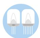
**VERSION À CÔNE OU À LAME D'AIR** - La version à cône d'air transmet le flux de manière uniforme. La version à lame élargit la zone de séchage.
