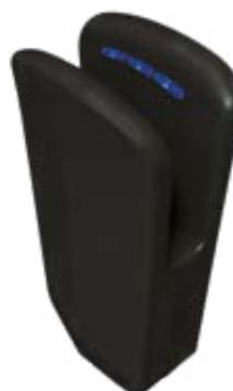
Beaucoup plus compact que les modèles de la même série, X-Dry Compact est conçu pour offrir un séchage efficace et ultra-rapide en seulement 12-15 secondes. Le séchoir comprend un moteur avec balais de 1.100 W et un élément chauffant réglable de 350 W. La présence d'une lampe UV antibactérienne, placée près du bac de récupération d'eau, garantit une hygiène durable et fiable.
