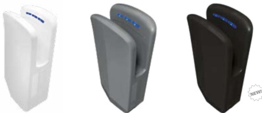
Beaucoup plus compact que les modèles de la même série, X-Dry Compact est conçu pour offrir un séchage efficace et ultra-rapide en seulement 12-15 secondes. Le séchoir comprend un moteur avec balais de 1.100 W et un élément chauffant réglable de 350 W. La présence d'une lampe UV antibactérienne, placée près du bac de récupération d'eau, garantit une hygiène durable et fiable.
