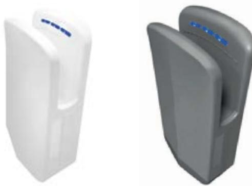
Beaucoup plus compact que les modèles de la même série, X-Dry Compact est conçu pour offrir un séchage efficace et ultra-rapide en seulement 12-15 secondes. Le séchoir comprend un moteur avec balais de 1.100 W et un élément chauffant réglable de 350 W. La présence d'une lampe UV antibactérienne, placée près du bac de récupération d'eau, garantit une hygiène durable et fiable.
